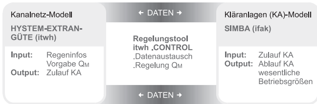
Abb. 3: Kopplung von Hystem-Extran-Güte und Simba via itwh Control
